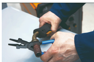
Снятие и установка сопла
