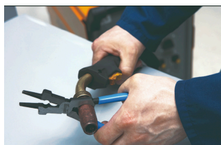
Rimozione ed installazione degli ugelli
