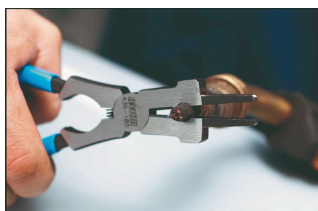
Rimozione e installazione della punta
