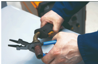
Αφαίρεση και τοποθέτηση φλογοκρύπτη
