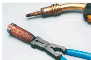
Nettoyage des éclaboussures sur la buse
