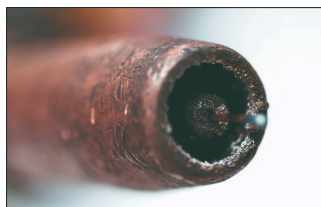
Uklanjanje nečistoće i ostatka vara sa i iz unutrašnjosti mlaznice
