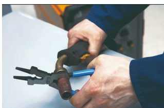
Gasdüse demontieren und montieren
