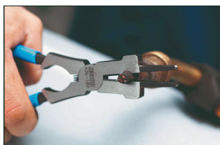
Stromdüse demontieren und montieren
