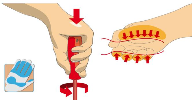
Große Handkontaktfläche = mehr Drehkraft
