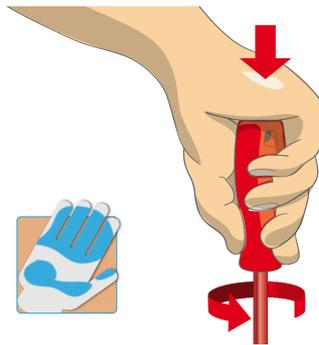
Surface maximale au contact de la main = puissance de couple accrue
