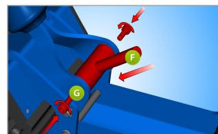
Вставьте новую ручку рычага (более короткую) (F) между металлической частью ручки и закрепите её на ручке с помощью двух винтов М4 (G).
