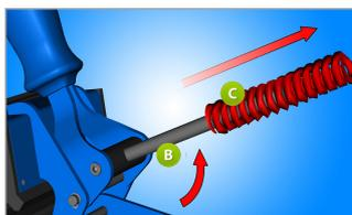
Вытолкните ручку в сторону тисков и вытяните ручку рычага (В) из направляющего рычага, затем удалите пружину (С).
