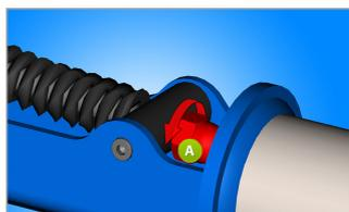
С помощью ключа вывинтите гайку М8 (А) с ручки рычага. Будьте **ОСТОРОЖНЫ** во время отвинчивания: Пружина сжата и может выскочить.
