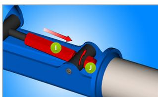
Протолкните установочную гайку М8 (I) через направляющий рычаг и с помощью ключа на 13 прикрепите новую шестигранную гайку М8. Одновременно удерживайте гайку М8 (J) другим ключом на 13. Завинтите шестигранную гайку М8 так, чтобы имелся маленький зазор между ней и направляющим рычагом, таким образом можно будет завинчивать или отвинчивать гайку.
