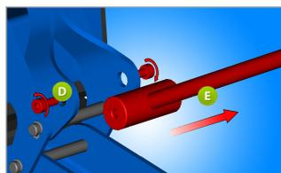
Отвинтите винты М4 (D) с ручки и удалите ручку рычага (E), которая не потребуется для системы с винтом.
