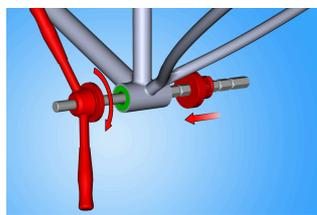
Соберите чашки каретки и наш инструмент запрессовки чашек подшипников (элемент 1680/4) как показано на рисунке. Поворачивайте ручки пресса чашек подшипников, постоянно контролируя выравнивание чашек. Продолжайте прессование, пока каждая чашка полностью не запрессуется в раму.
