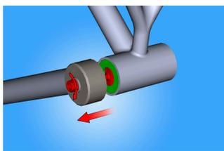
Для снятия чашки подшипника из рамы велосипеда навинчивайте гайку, пока съёмник полностью не извлечёт чашку из рамы. Повторите эти действия на противоположной стороне каретки.
