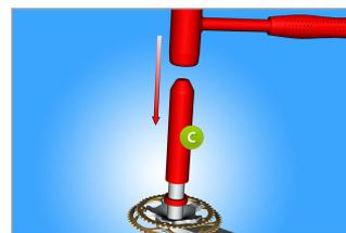
Pour installer le roulement de la manivelle, on utilise l'outil pour installation de roulements (C) et un marteau.
