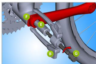
Pour enlever la manivelle en aluminium Campagnolo® Ultra Torque, insérer d'abord fermement la fine plaque protectrice (F) entre la manivelle et la cuvette du jeu de pédalier. Ensuite, insérer la rallonge d'arbre (E) dans le jeu de pédalier et à l'aide de l'extracteur universel (B), enlever la manivelle en faisant tourner l'arbre dans le sens des aiguilles d'une montre à l'aide d'une clé ou d'un cliquet 19 mm.
