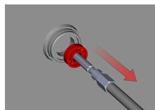
Plusieurs coups de marteau coulissant permettent le démontage rapide et facile du roulement, sans aucun dommage.
