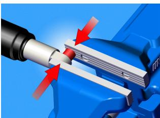
nova čaura postavlja se paralelno sa otvorom amortizera i zajedno se postavljaju u stegu. Jednakomernim pritiskanjem stege čaura se postavlja u kućište amortizera.
