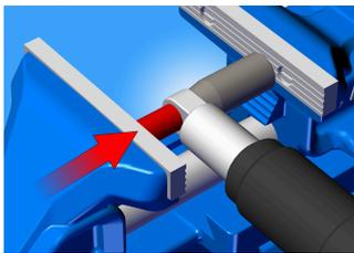
Собранный инструмент вместе с амортизатором помещается в тиски. Теперь втулка выдавливается из амортизатора с помощью тисков. Втулка выжимается в большую часть инструмента, откуда она может быть легко удалена.
