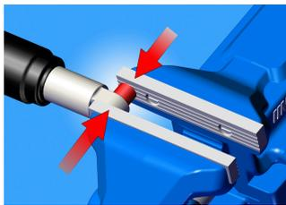
Impostare la nuova boccola di supporto parallelamente all'apertura sul corpo dell'ammortizzatore e serrare il tutto con una morsa. Quindi premere la boccola nel cuscinetto, serrando completamente nel corpo dell'ammortizzatore.
