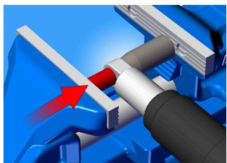
Το συναρμολογημένο εργαλείο, μαζί με τον απορροφητήρα τοποθετείται στη μέγγενη. Το κουζινέτο πιέζεται προς το μεγαλύτερο μέρος του εργαλείου, απ' όπου μπορεί να αφαιρεθεί εύκολα.
