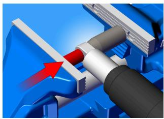
Alat se postavi zajedno s amortizerom u stegu i jednakomjernim stezanjem stegje čahura se istisne iz amortizera. Na taj način, čahura se zapravo pomakne u širi dio alata, odakle se jednostavno izvadi.
