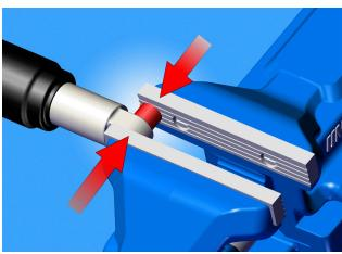
Nova čahura postavlja se paralelno s otvorom amortizera i zajedno se postavljaju u stegu. Jednakomjernim pritiskanjem stegje čahura se postavlja u kućište amortizera.
