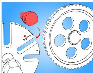
Вставьте лапки съёмника (3 шт.) в прорези съёмника, отмеченное количество прорезей шкива. Например: если шкив имеет 5 отверстий, вставьте лапки съёмника (3 шт.) во все прорези съёмника со знаком номера 5.
