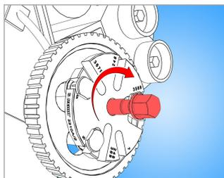
Поворачивайте ходовой винт съёмника в направлении по часовой стрелке, пока шкив не снимется.
