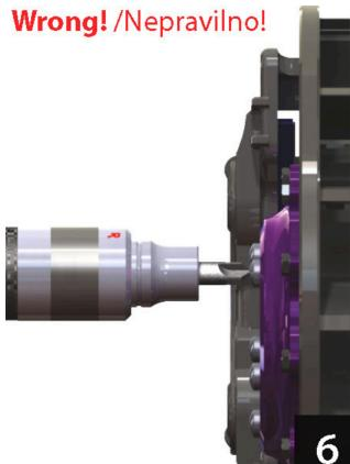
5 Alat postavljamo na vijak i ne pritiskamo ga u konačnu poziciju prije upotrebe. Udarcem čekića dolazi do automatskog stiska i odvrtanja/zatezanja vijka.
