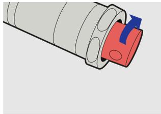
Ziehen Sie die untere Schraube fest, um die Drehmomenteinstellung zu fixieren.
