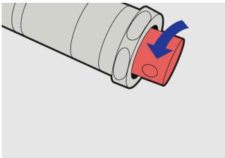
Lösen Sie die untere Schraube, um den Einstellhebel für die Drehmomenteinstellung zu lösen.
