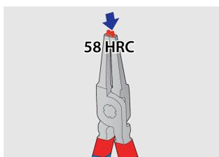
Наконечники, закалённые до твёрдости HRC 58, не сгибаются и не ломаются при работе со стопорными кольцами
