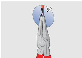
Les pointes des mâchoires sont orientées à un angle de 9° pour donner un maximum de prise sur le circlip et empêcher tout glissement.
