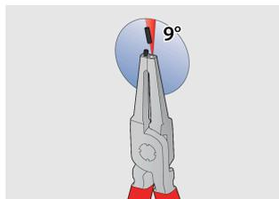
Le punte sono inserite nella ganascia all'angolo che impedisce all'anello elastico di scivolare
