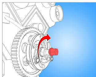
za pričvršćivanje izvlakača na remenicu okrećite vreteno u smeru kazaljke na satu dok se izvlakač ne pričvrsti
