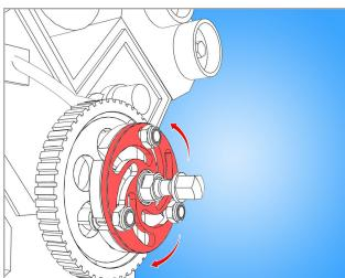
okretanjem ploče podešava se položaj kraka izvlakača, tako da se izvlakač može čvrsto postaviti na remenicu koja se skida
