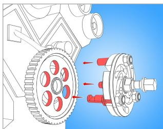
postavite krake izvlakača u otvore remenice
