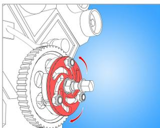
Поверните установочную пластину для смещения лапок съёмника, чтобы они надёжно захватили шкив.
