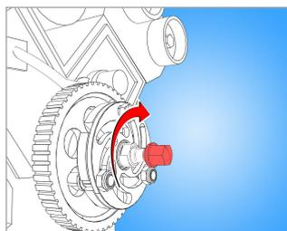
Поворачивайте ходовой винт съёмника в направлении по часовой стрелке, пока шкив не снимется.
