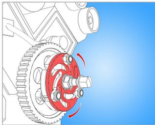
Girare l'impostazione della piastra per spostare le gambe dell'estrattore, in modo da afferrare saldamente la puleggia.
