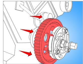
Una volta finito di lavorare, rimuovere l'estrattore.
