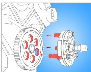
Postavite krake izvlakača u otvore remenice
